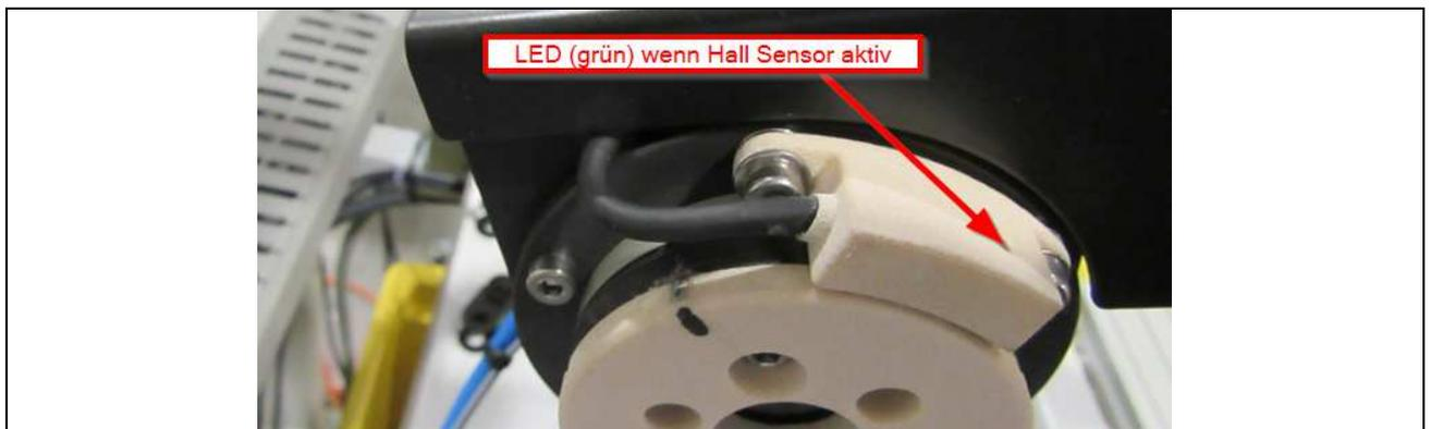
Abb. 4: Prototypische Einbausituation des Sensors am Gelenk RL-D-20
