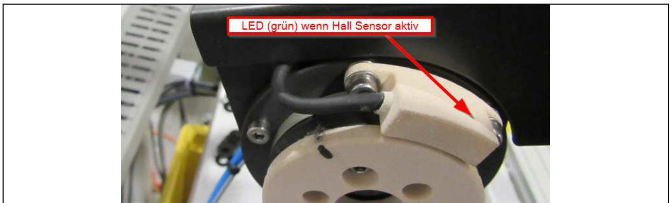
Abb. 4: Prototypische Einbausituation des Sensors am Gelenk RL-D-20
